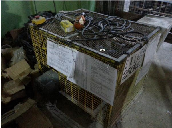
**安全護罩** - 覆蓋絞車危險轉動部份，確保操作絞車時不可移除護罩
