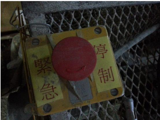
**緊急停機掣** - 操作絞車前先測試確保其有效性
